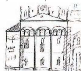
Fig. 24 Schizzo a mano che mostra la serie di aperture individuate. (Sandonnini 1900) Dei due accessi A- B indicati nel disegno, quello più alto il B immetteva dal presbitero alla sagrestia salendo alcuni gradini, da cui poi si accedeva alla torre attraverso un'apertura ricavata in prossimità dello spigolo sud ovest. L'accesso denominato con la lettera A venne utilizzato quando all'inizio del '500 venne rifatto il voltone tra i due archi di collegamento e impostato a una quota inferiore (fig. 24). Da qui si comprende come il collegamento tra torre e Duomo fosse costituito da setti murari, solai e archi. Il ruolo statico di queste strutture venne ampiamente dibattuto agli inizi del 1900 al momento della demolizione durante i lavori di isolamento del Duomo. Per comprenderne l'utilità da un punto di vista statico si iniziarono una serie di studi legati all'analisi della pendenza e della stabilità della torre, inoltre si eseguirono dei saggi sulle fondazioni dei piedritti degli archi. Sketch representing the series of individuated openings (Sandonnini 1900). The upper access B is introduced from the presbytery to the sacristy by climbing up few steps, and then from here to the Tower across an opening that is close to the southwest corner. The access A had been used in the beginning of the 1500s, when the big vault lying at a lower height was made again, between the two arches that link the Tower and the Cathedral. The connection between Tower and Cathedral was made by walls, floors and arches. The static role of these structures was widely debated in the early 1900s, until their demolition during the isolation works of the Cathedral. To understand the usefulness of these structures from a static point of view, several investigations were begun on slope analysis and Tower stability. Further, several samples were extracted from the foundations of the arches' abutments.
