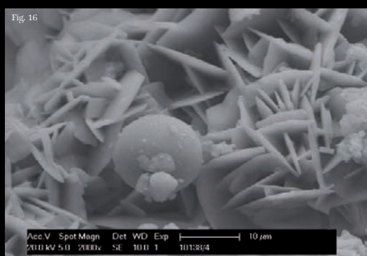
Fig. 15 Micrografia al SEM, superficie del campione 4, prospetto est. In evidenza globulo di provenienza atmosferica di natura biologica. SEM micrograph of sample 4, eastern elevation. Shows a globule of atmospheric origin and a biological nature.
