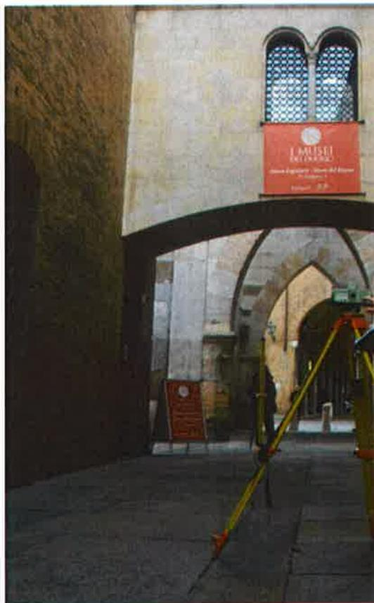
*Figura 1. A sinistra: microrete di livellazione installata in Piazza Grande a cura del Comune di Modena, capisaldi esistenti. A destra: campagne di livellazione di elevata precisione nel complesso monumentale di Piazza Grande (particolare di via Lanfranco). Strumentazione utilizzata: livello Leica DNA03, stadia invar*
